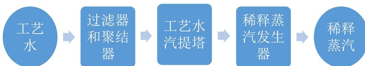
由急冷水沉降槽水侧排出的工艺水，经过工艺水汽提塔进料泵（P-106）加压后，送入工艺水进料预热器（E-122），用盘油加热后，进入工艺水汽提塔。工艺水汽提塔用塔釜再沸器或低压蒸汽汽提，塔顶汽提出的酸性气体和轻烃返回到 C-103。
